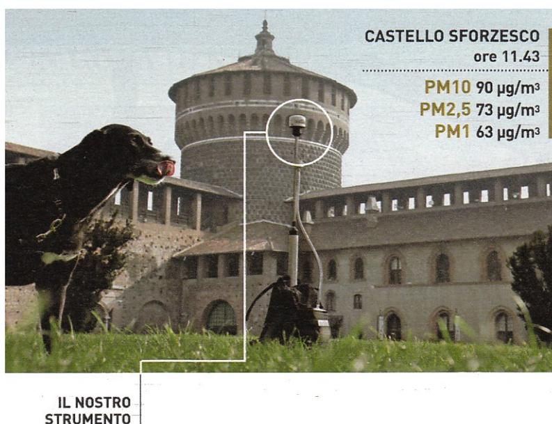
*Nel cortile del Castello Sforzesco a Milano, il PersonalDustMonit della Con.Tec Engineering, utilizzato per il nostro monitoraggio dell'aria. "E' uno spettrometro a laser scattering che misura e registra in tempo reale le concentrazioni nell'atmosfera di PM10, PM2,5 e PM1 e il numero delle particelle suddivise in classi granulometriche da 0,3 a 10 micron" spiega l'ingegner Carlo Giglioni (per info [www.conteng.it](http://www.conteng.it)).*
