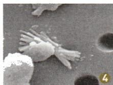
**4. GESSO** Bacchette di gesso, probabilmente provenienti dai cantieri edili (notare la dimensione fine accanto a quella della foto del filtro-2µm)
